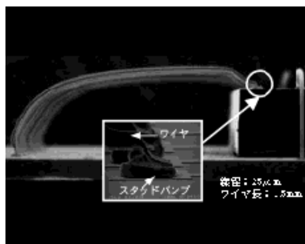
図2 スタック接合用ボンディングワイヤ
